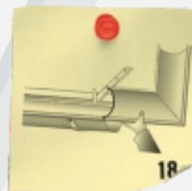
Narożnik z rynną łączymy w sposób taki sam, jak dwie rynnę lecz bez łącznika. Należy zwrócić uwagę aby rynną z obu stron wchodziła do wnętrza narożnika. W celu wzmocnienia połączenia rynnę i narożnik należy połączyć dodatkowo nitami szczelnymi po 4 szt. z każdej strony.
