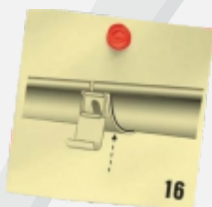
Połączenie rynien wzmacniamy zakładając na nie łącznik z uszczelką EPDM. W przypadku rynien w rozmiarze 190 (400 mm) nie używamy łącznika, a rynnę dodatkowo w celu wzmocnienia łączymy nitami szczelnymi.
