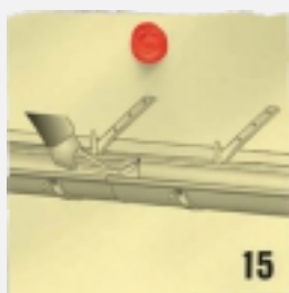
Tylne krawędzie rynny ściskamy ze sobą.
