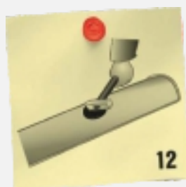
Ostre krawędzie otworu zaginamy na zewnątrz.
