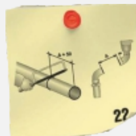
Łączenie wylotu z rurą spustową osiągamy za pomocą dwóch kolan o takim samym kącie i rury łączącej. Kolanko górne łączymy z wylotem za pomocą 2 szt. nitów szczelnych, które uniemożliwiają jego wysunięcie. Rurę łączymy z kolankiem dolnym 2 nitami. Pierwsza obejma rury powinna znajdować się ok. 15 m, m poniżej kolanka.
