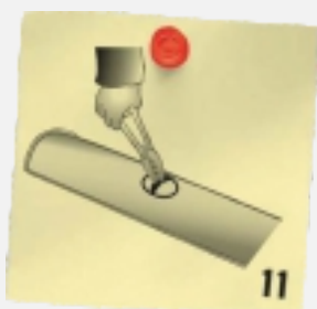
Otwór precyzyjnie docinamy za pomocą nożyc do metalu.
